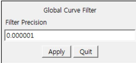
CAD file Import시 Precision 차이로 인해 한 개의 Curve 가 발생 하여야 될 구간에 여러 개의 Curve 가 발생 하는 경우가 생김.
